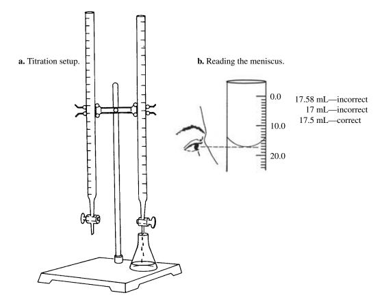
**Figure 23.1** • Titration setup.
